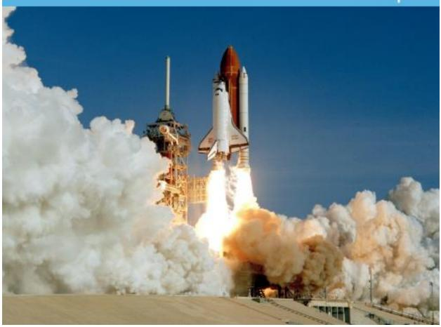
بخش زیادی از دودی که هنگام پرتاب شاتل فضایی فوران می کند، دود خروجی از موشک نیست. این دود، بخار آبی است که از استخر آب زیر شاتل برمی خیزد و این استخر برای آن طراحی شده که امواج شوک صوتی را جذب کند، در غیر این صورت، فضاپیما تکه تکه می شود.
